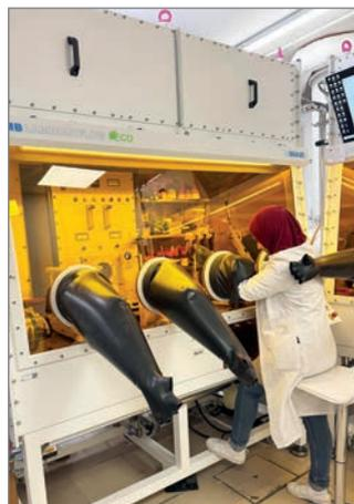
tamente sigillato, privo di ossigeno e polvere. Il motivo? *"Ogni fase della lavorazione deve essere eseguita con precisione assoluta. Per questo utilizziamo guanti integrati nelle camere di manipolazione: ci permettono di lavorare senza contaminare i materiali"*. Un settore in piena evoluzione, che potrebbe rivoluzionare il modo in cui produciamo energia.
