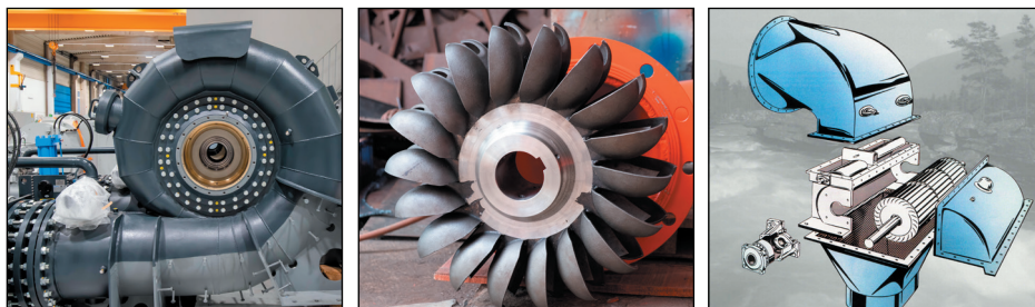
Figura 7. Turbine tradizionali per utilizzo nelle WTN (da sinistra, turbine Francis, Pelton e Banki)
