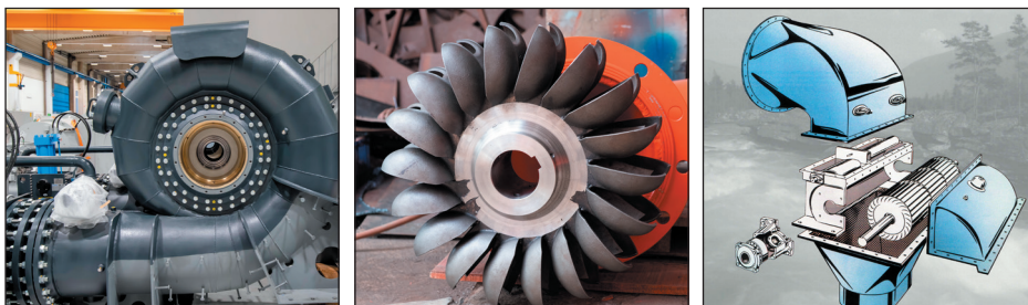
Figura 7. Turbinas tradicionales para su uso en WT (desde la izquierda turbinas Francis, Pelton y Banki)
